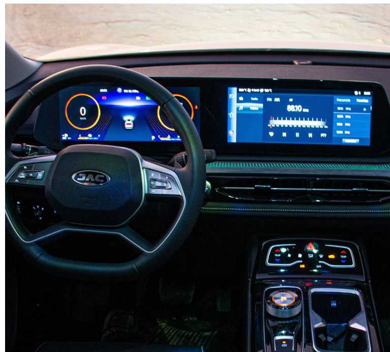
Два 12.3" цветных экрана формируют единую цифровую панель: левый выводит показания приборной панели, а правый отображает данные информационно-развлекательного комплекса.
