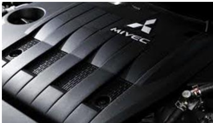
Турбированный двигатель Mitsubishi 4A95TD мощностью 197 л.с.
